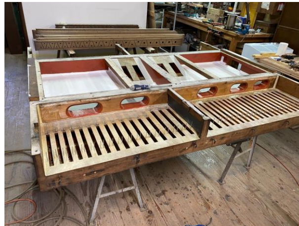
Visuel 8 : Obturation des gravures avec de la peau d'agneau et remise en place des soupapes. La peau d'agneau a préalablement été recouverte de colle de lapin avec de l'ocre rouge, afin de la rendre parfaitement étanche. Chaque soupape correspond à une touche d'un clavier (5 claviers). © Christian Lutz, Etablissement public chargé de la conservation et de la restauration de la cathédrale Notre-Dame de Paris
