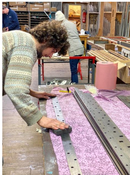
Visuel 12 : Martin Viallet, apprenti à la Manufacture Languedocienne de Grandes Orgues à l'œuvre sur les registres. Chaque registre correspond à une couleur sonore différente sur l'étendue du sommier, soit 56 notes (115 registres) pour le grand orgue. © Christian Lutz, Etablissement public chargé de la conservation et de la restauration de la cathédrale Notre-Dame de Paris
