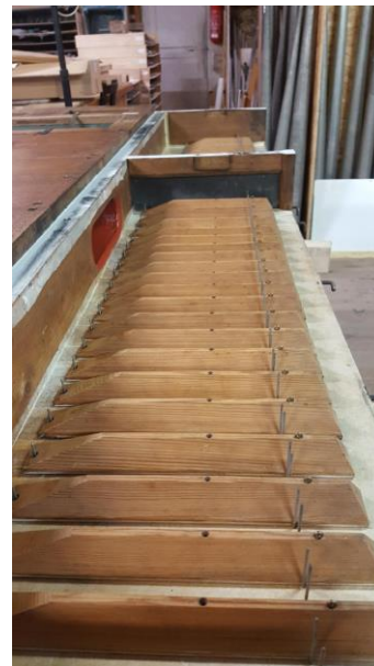
Visuel 10 : Vue des soupapes. Le sommier est à nouveau testé en condition de marche. © Charles Sarélot / Manufacture Languedocienne de Grandes Orgues
