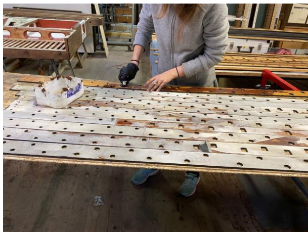
Visuel 13 : Une factrice d'orgues, à l'œuvre sur les registres. Chaque registre correspond à une couleur sonore différente sur l'étendue du sommier, soit 56 notes (115 registres) pour le grand orgue. © Christian Lutz, Etablissement public chargé de la conservation et de la restauration de la cathédrale Notre-Dame de Paris
