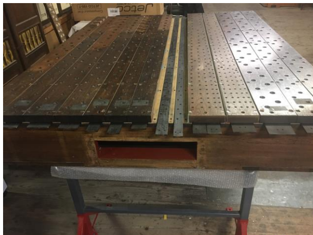
Visuel 11 : Ajustage des registres. Chaque registre correspond à une couleur sonore différente sur l'étendue du sommier, soit 56 notes (115 registres) pour le grand orgue. © Charles Sarélot / Manufacture Languedocienne de Grandes Orgues
