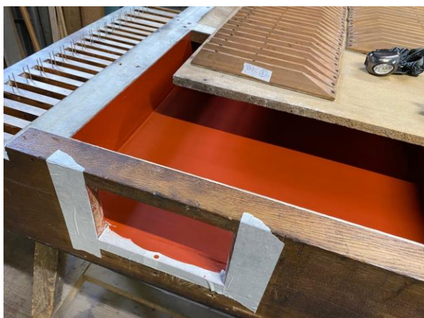
Visuel 9 : Obturation des gravures avec de la peau d'agneau et remise en place des soupapes. La peau d'agneau a préalablement été recouverte de colle de lapin avec de l'ocre rouge, afin de la rendre parfaitement étanche. Chaque soupape correspond à une touche d'un clavier (5 claviers). © Christian Lutz, Etablissement public chargé de la conservation et de la restauration de la cathédrale Notre-Dame de Paris
