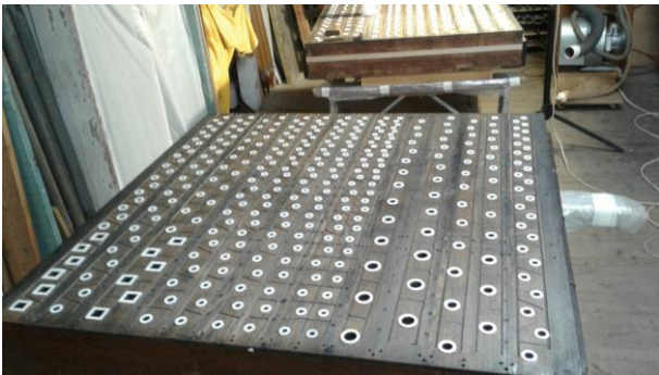
Visuel 7 : Dé-graphitage de la table et des chapes puis collages (à la colle de poisson) d'un joint d'étanchéité sur chaque perce (trou). Chaque perce alimente un tuyau. © Charles Sarélot / Manufacture Languedocienne de Grandes Orgues
