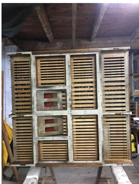
Visuel 5 : Démontage de tous les éléments qui constituent le sommier (chapes, registres, soupapes, ressorts, boursettes), démontage des fonds du sommier et mise à nu de la grille. © Charles Sarélot / Manufacture Languedocienne de Grandes Orgues
