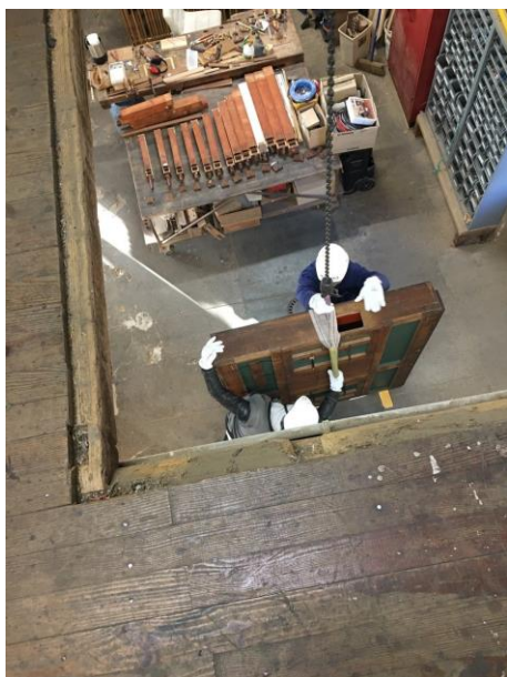
Visuel 3 : Levage d'un sommier à la Manufacture Languedocienne de Grandes Orgues, préalablement décontaminé par l'atelier Quoirin. © Charles Sarélot / Manufacture Languedocienne de Grandes Orgues
