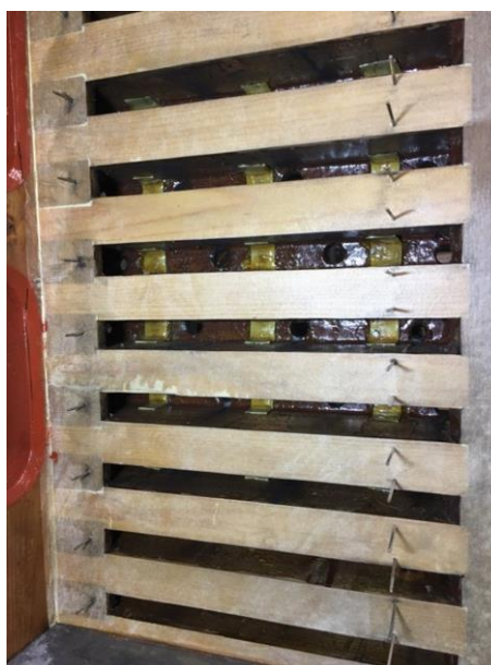
Visuel 6 : Ré-encollage des gravures et de la table à la colle chaude (d'os et nerfs) pour obtenir une parfaite étanchéité entre les gravures. Chaque gravure correspond à une note du clavier. © Charles Sarélot / Manufacture Languedocienne de Grandes Orgues
